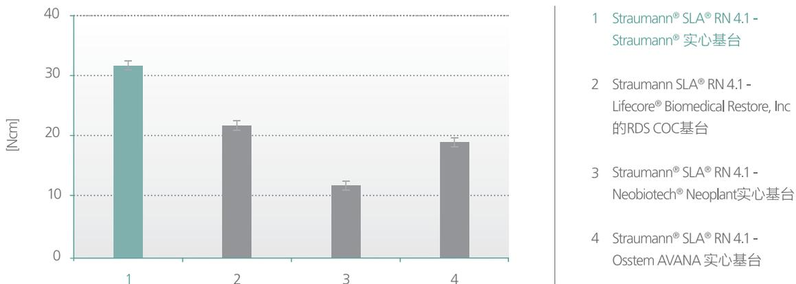
原配士卓曼基台 - 种植体系统表明了对螺丝松动的影响最小 - 由循环负载后最高旋出扭矩<sup>2</sup>反映出来。
